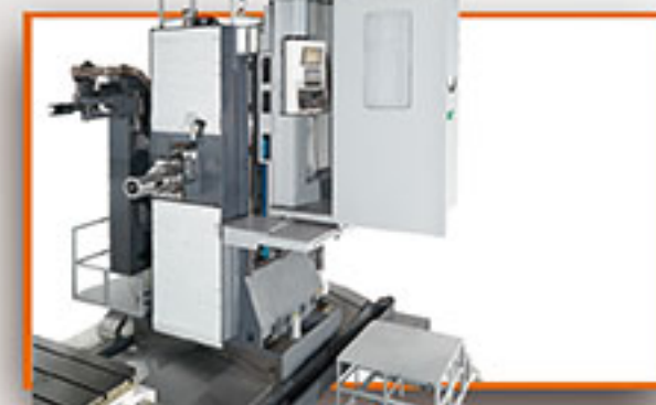
高空換刀之踏板設計操作箱獨立升降。
