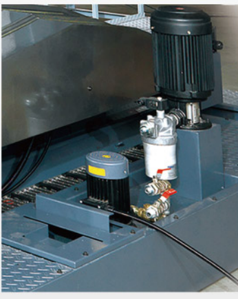
20 BAR 中心出口水泵浦。
